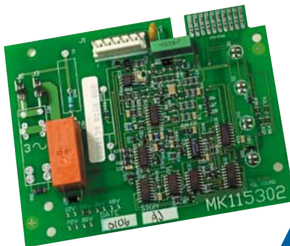
Kretskort med övervakningsfunktioner ger en säker laddning.
